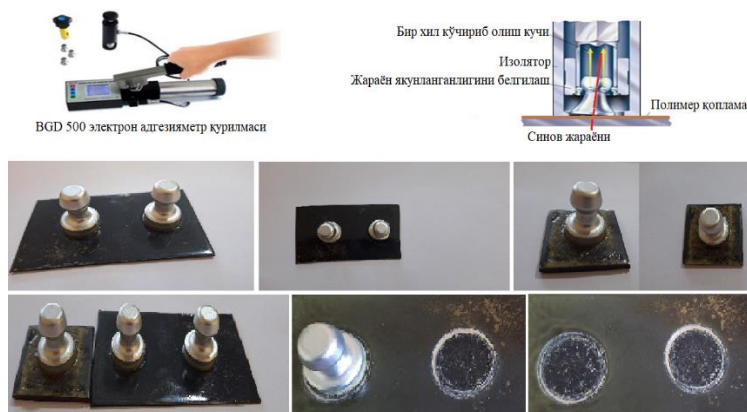
1-расм. BGD-500 электрон қурилмасы ёрдамида интерполимер қопламаларни адгезиясини аниқлаш учун тайёрланган намуналар ва тажриба синов жараёнлари.
