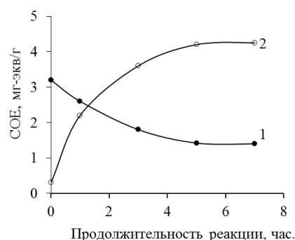
Рис. 2. Зависимость СОЕ по HCl (1) и NaOH (2) от продолжительности реакции. (Т=80°C, [МА]=20%, модуль ванны 20).
