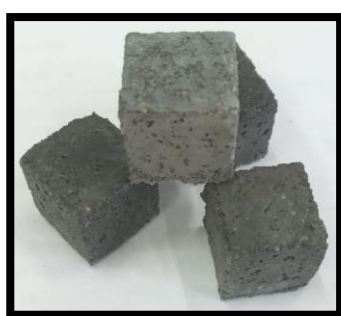
Рис.1 Образцы-кубы размером 2х2х2 см из цементно-песчаных растворов состава 1:3, твердевших в течение 3 мес. а) в H 2 O; б) в 3%-ном растворе Na 2 SO 4 ; с) в 1%-ном растворе MgSO 4
