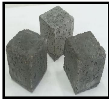
Рис.1 Образцы-кубы размером 2х2х2 см из цементно-песчаных растворов состава 1:3, твердевших в течение 3 мес. а) в H 2 O; б) в 3%-ном растворе Na 2 SO 4 ; с) в 1%-ном растворе MgSO 4
