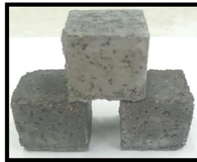
Рис.1 Образцы-кубы размером 2х2х2 см из цементно-песчаных растворов состава 1:3, твердевших в течение 3 мес. а) в H 2 O; б) в 3%-ном растворе Na 2 SO 4 ; с) в 1%-ном растворе MgSO 4
