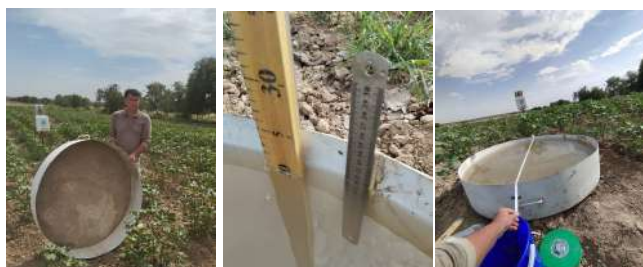
2-rasm Tajriba dalasida ochiq suv yuzasidan bo‘ladigan bug‘lanishni aniqlash jarayoni.
