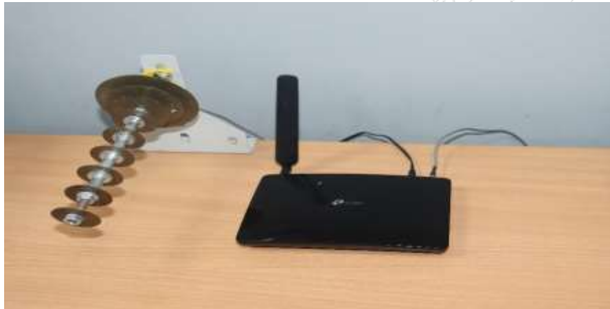
2-rasm. (1km) Uzoq masofaga simsiz tarmoq qurish qurilmasining ko'rinishi.
