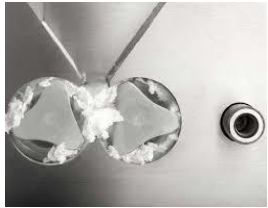
2-расм. Брабендер пластографи ёрдамида композицион материаллар олиш жараёни
