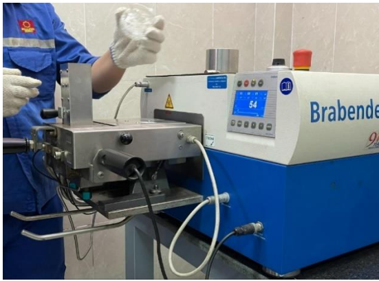
2-расм. Брабендер пластографи ёрдамида композицион материаллар олиш жараёни
