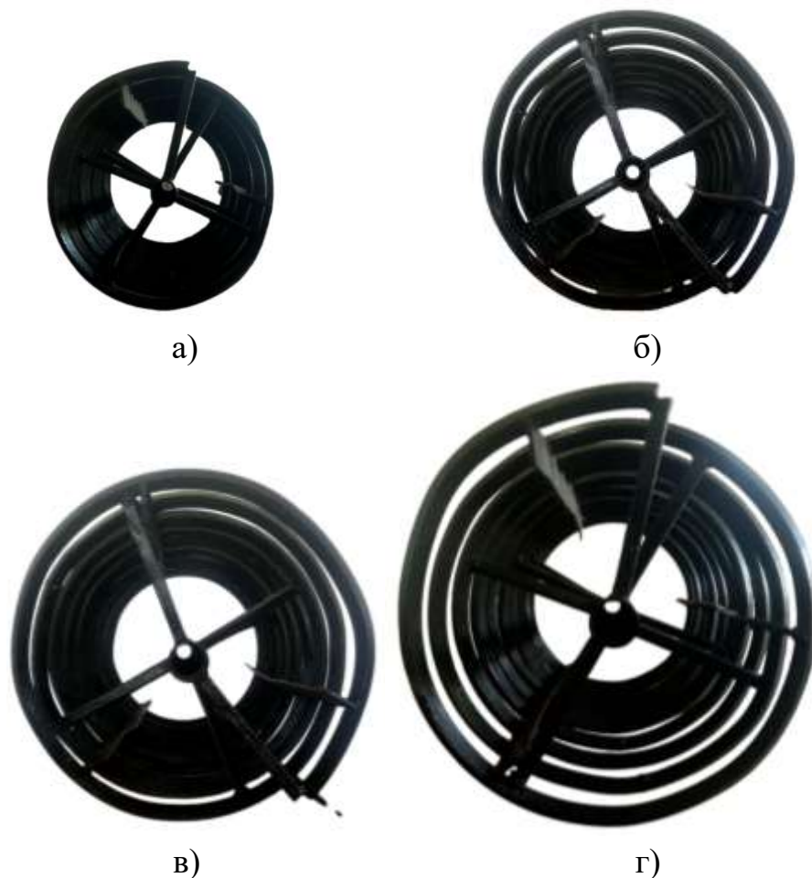
2-расм. Диаметри 30 (а), 35 (б), 40 (в) ва 45 (г) см бўлган комбинациялашган машина ротацион иш органлари
