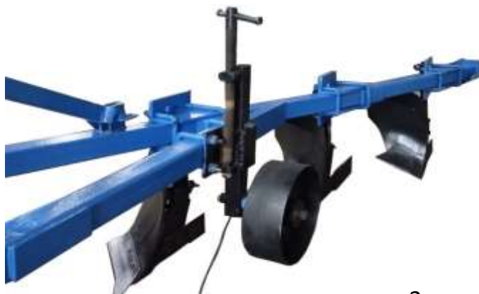
2-расм. Ишлов бериш чуқурлигини назоратлайдиган қурилманинг машина рамасига ўрнатилган ҳолатдаги кўриниши
