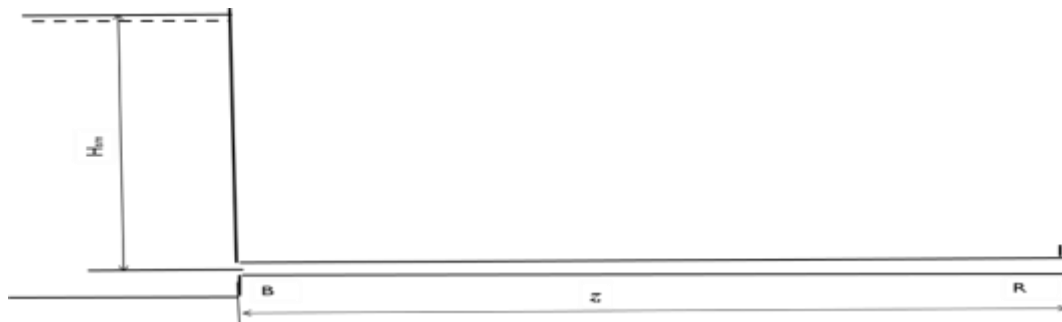
Рис. 1. Неустановившееся движение жидкости, вызванное мгновенным открытием концевой задвижки
