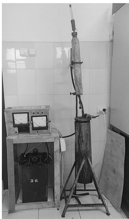
1 – емкость для воды; 2 – манометр (образцовый); 3 – медный капилляр; 4 – парогенератор; 5 – печь карбонизации и активации; 6 – латоры; 7 – милливольтметры; 8 – холодильник; 9 – приемник; 10 – газовый счетчик; 11 – стабилизатор давления; 12 – карман термопары
