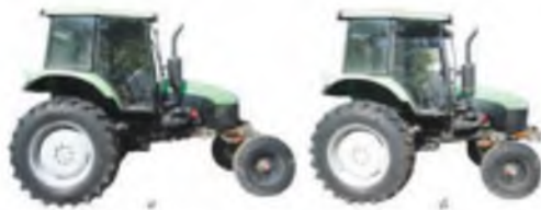
Рис. 1. Универсально-пропашной трактор с изменяемой базой в приращенной (а) и укороченной (б) базе.
