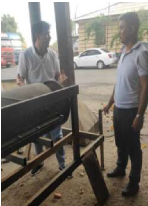
1-rasm: Makkajo'xori urug'ini maydalovchi drabilka
