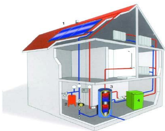
1-расм. Ясси қуёш коллекторли иссиқлик насосли иссиқлик таъминот тизими: 1- ясси қуёш коллектори; 2- кенгайтирувчи бак; 3- бак аккумулятор; 4 – иситиш қозони
