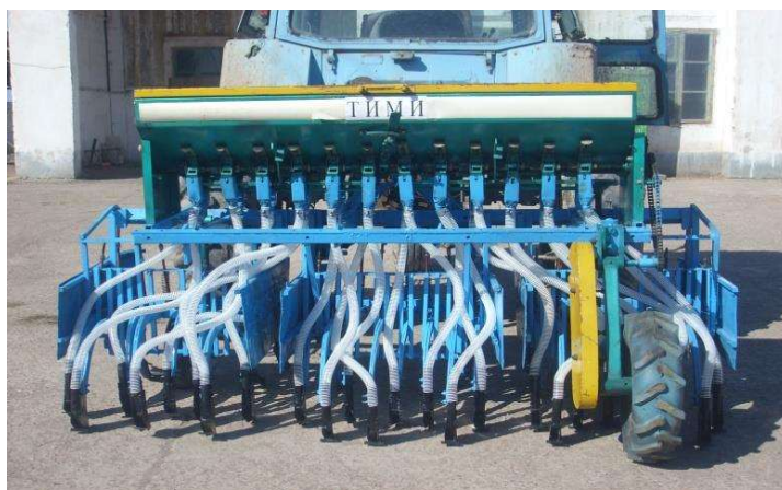
2-rasm. G‘o‘za qator orasiga kuzgi bug‘doy ekadigan ankerli ekkichlar bilan jixozlangan seyalka
