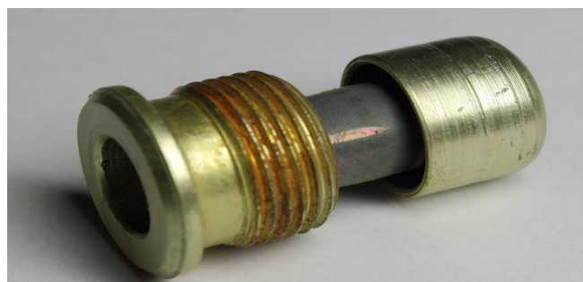
Рис. 3. Плутониевый источник АДИ из извещателей КИ и РИД
