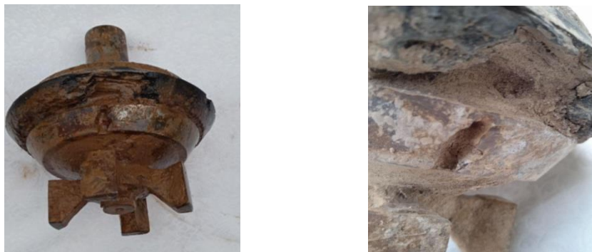
Рисунок 1. Ямки в рабочей поверхности клапана бурового насоса.
