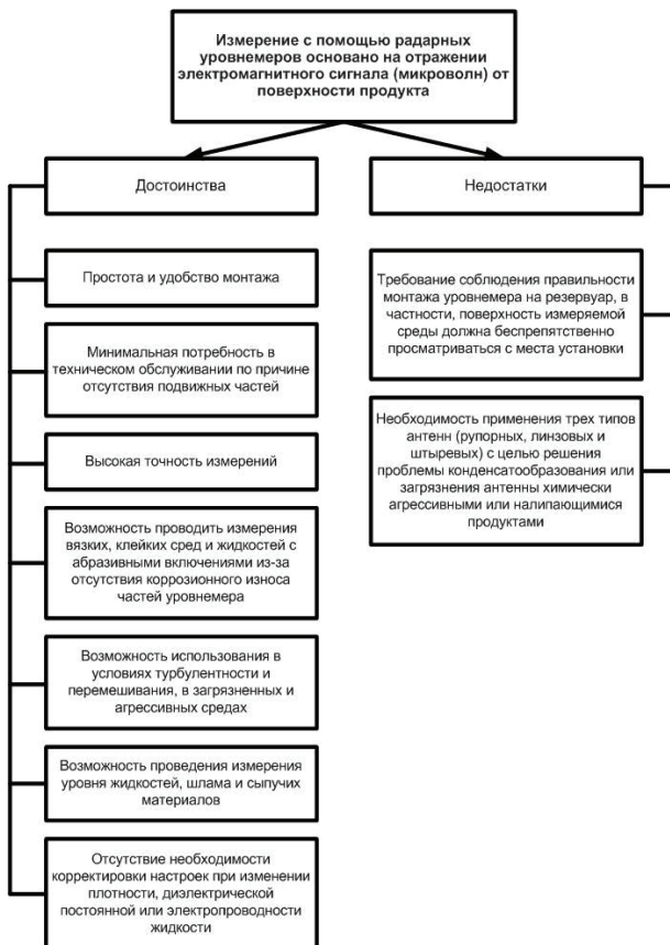
Рис. 2. Достоинства и недостатки бесконтактного радарного уровнемера
