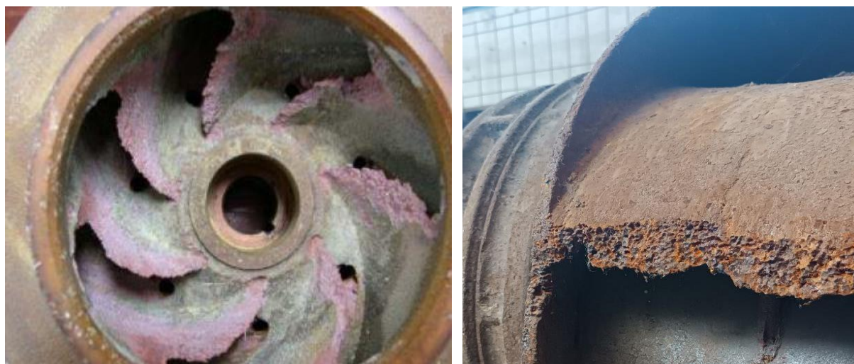
1-расм. КАК-1 насос станциясидаги марказдан қочма насос куракларига кавитация таъсири.
