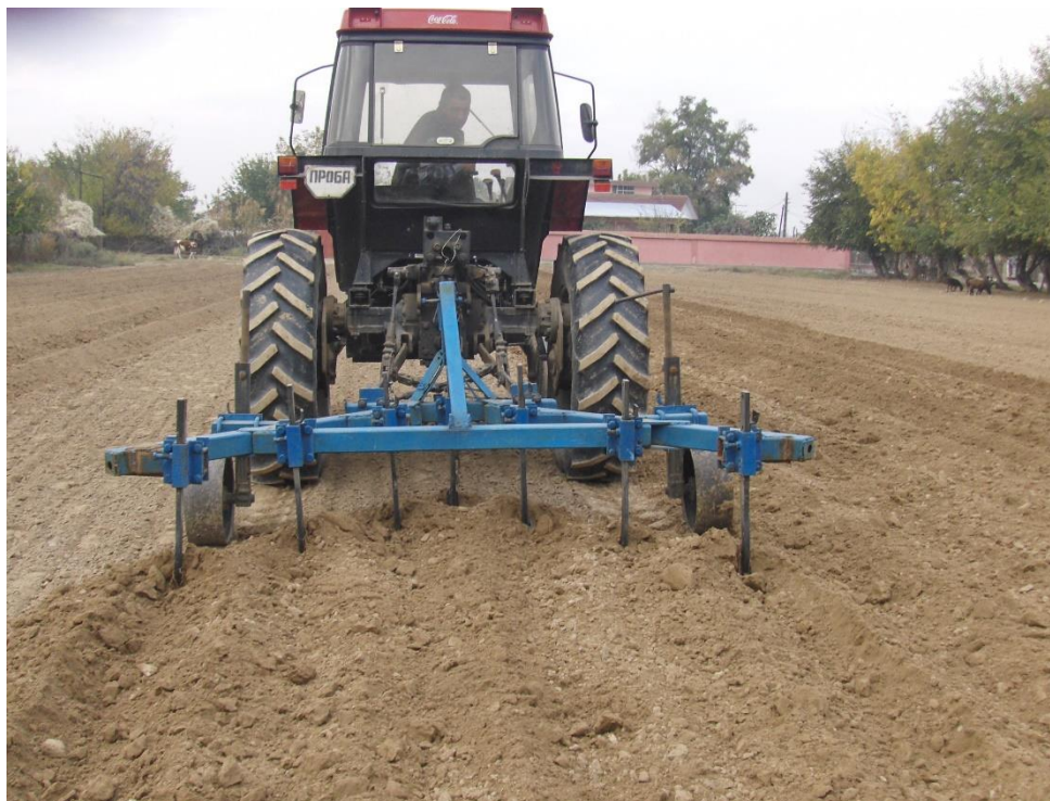
2-расм. Энергия-ресурстержамкор яссикескич-чукурюмшаткичнинг иш жараёнидаги кўриниши
