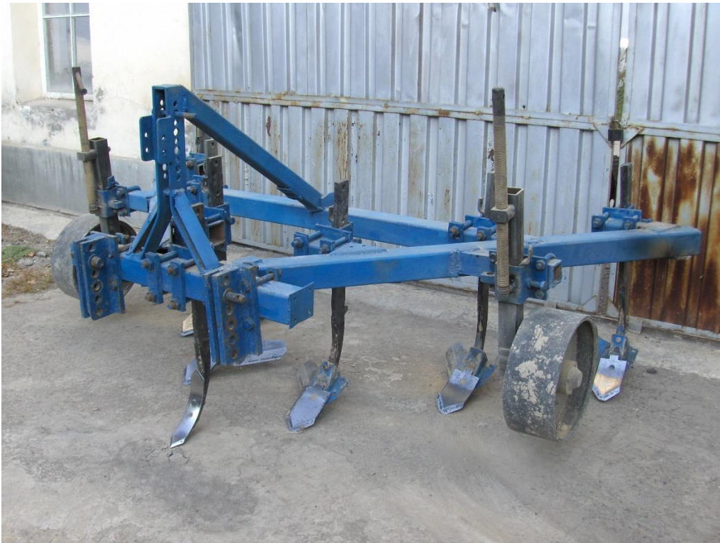
1-расм. Энергия-ресурстержамкор яссикескич-чукурюмшаткичнинг умумий кўриниши
