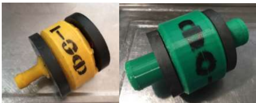
Рис. 2. Фильтры-омагничиватели воды ФО-1 и ФО-2 (изготовлены на 3D Принтере Creatbot D600 Pro)
