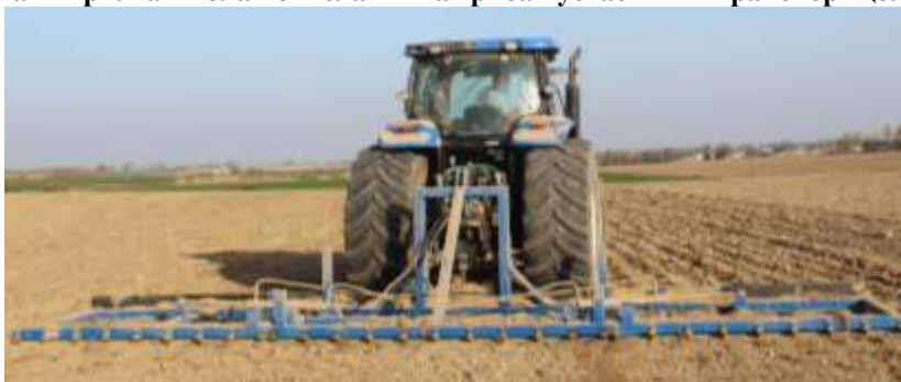
2-расм. Такомиллаштирилган мола-текислагич тажриба нусхасининг иш жараёндаги кўриниши
