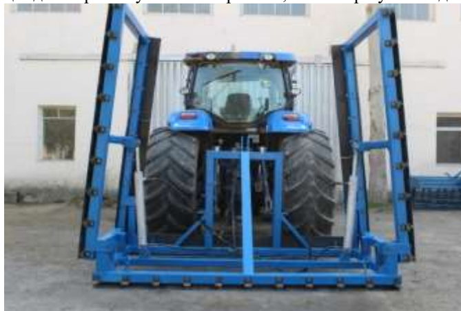
1-расм. Такомиллаштирилган мола-текислагич тажриба нусхасининг транспорт ҳолатдаги кўриниши
