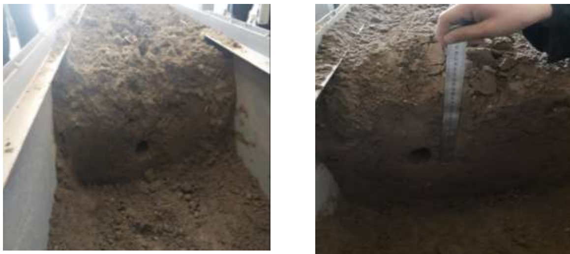
3-расм. Тавсия этилаётган янги туйнукли дренаж ҳосил қиладиган қурилманинг лаборатория шароитида туйнуқлар ҳосил қилиш жараёни тажриба натижалари
