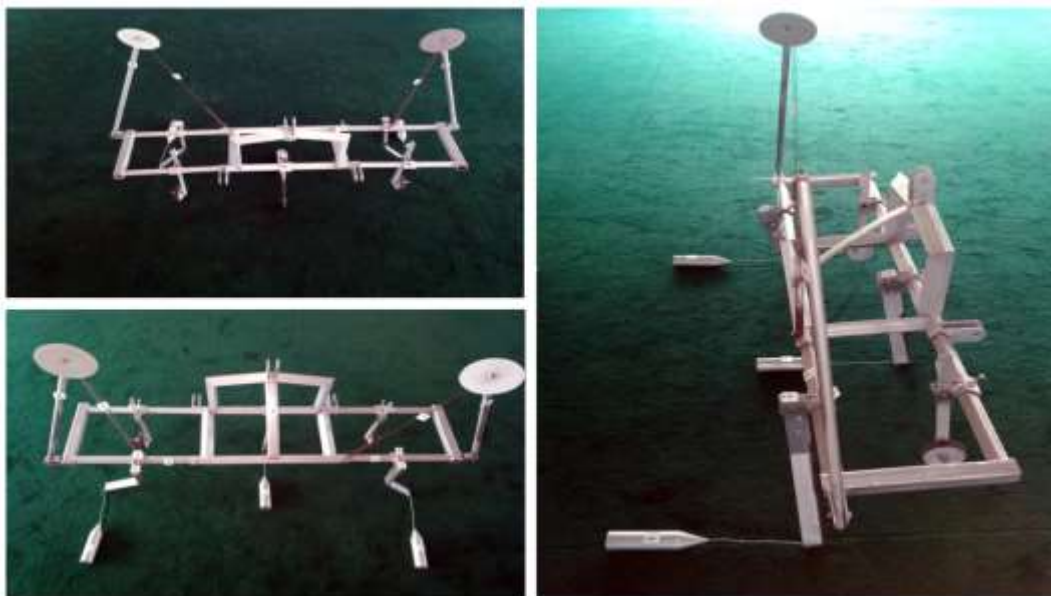
2-расм. Туйнукли дренаж ҳосил қиладиган янги қурилманинг лаборатория шароитидаги макети
