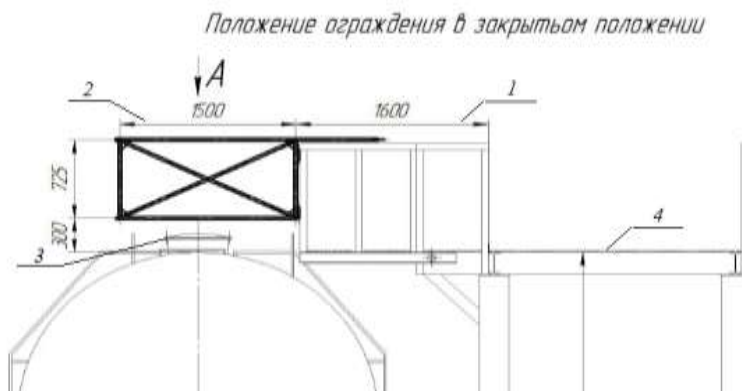
1 – откидной мостик; 2 – складное ограждение; 3 – люк цистерны; 4 – эстакада.
